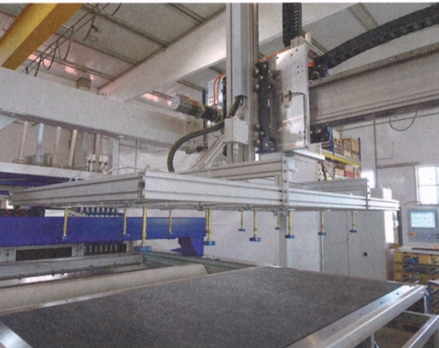
Reinwasserstrahl-Schneidanlage mit vier umlaufenden Wechseltischen, acht Schneidköpfen und einer automatischen Beladestation mit Rollon-Achsroboter. (Bild: Perndorfer)
