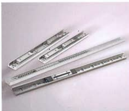
Die Serie Easyslide ist ein Linearführungssystem mit Schienen und Läufern aus kaltgezogenem Stahl und induktiv gehärteten Laufflächen.
