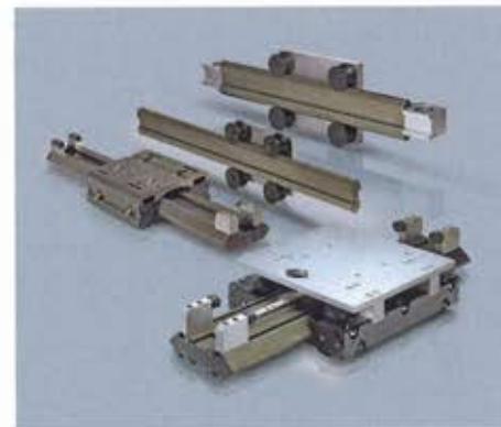
Als hochbelastbares System muss die Speedy Rail weder gewartet noch geschmiert werden und gewährleistet auch in schmutziger Umgebung einen zuverlässigen und ruhigen Betrieb.
