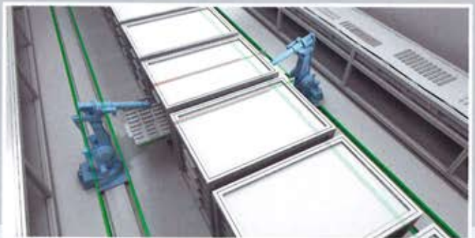
05 Mehrachssysteme kommen z. B. für die Bestückung von Werkzeugmaschinen oder für Verpackungsanlagen zum Einsatz
