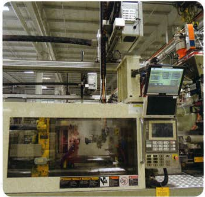
Das Unternehmen Stone Plastics baut im eigenen Haus kundenspezifisch anpassbare kartesische Roboter für die Herstellung von Kunststoffteilen, um die Kosten besser steuern und überwachen zu können.
